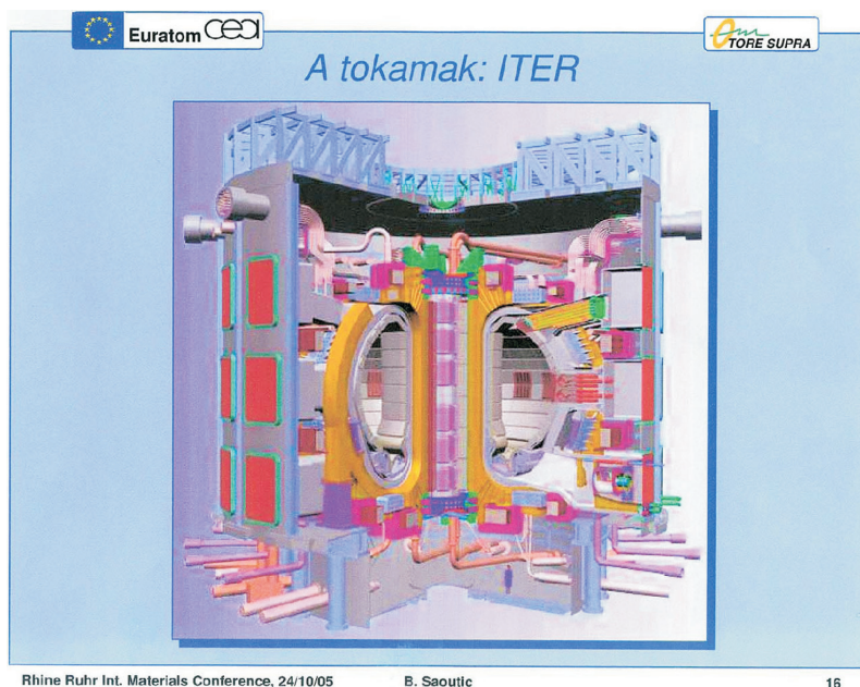
Slika 11. Shema fuzijskog eksperimentalnog reaktora ( International Thermonuclear Experimental Reactor – ITER )
