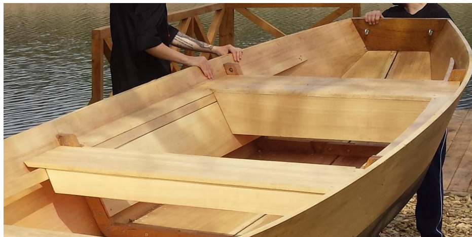
Slika 3: Smještaj uzgonskih elemenata (Porinuće čikla na lokaciji Otočki virovi).
