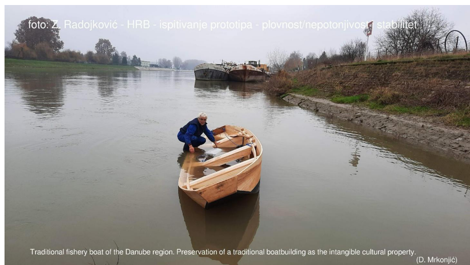
Slika 7: Ispitivanje prototipa – plovnost, nepotonjivost stabilitet.
