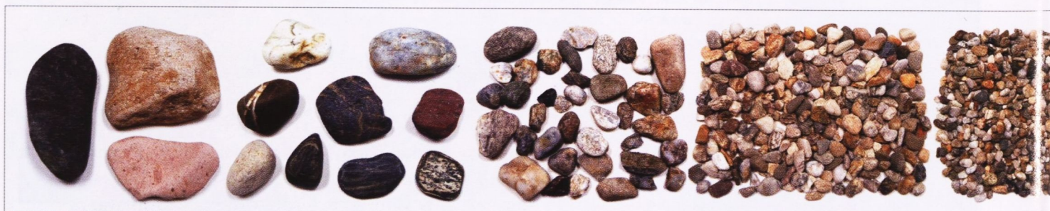
Granulometrijska analiza – sortiran šljunak eksploatacijskog polja Motičnjak: do 150 mm, više od 32 mm, od 16-32, od 8-16, te 4-8 mm i zrnca pijeska manja od 4 mm
